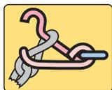
クロスチェーンの端の中へバックルコネクタフックを通して、フックをコネクタにかける。
